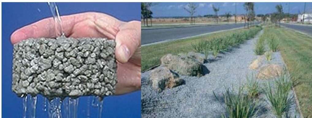
*A esquerda concreto permeável e a direita Trincheira de Infiltração*
