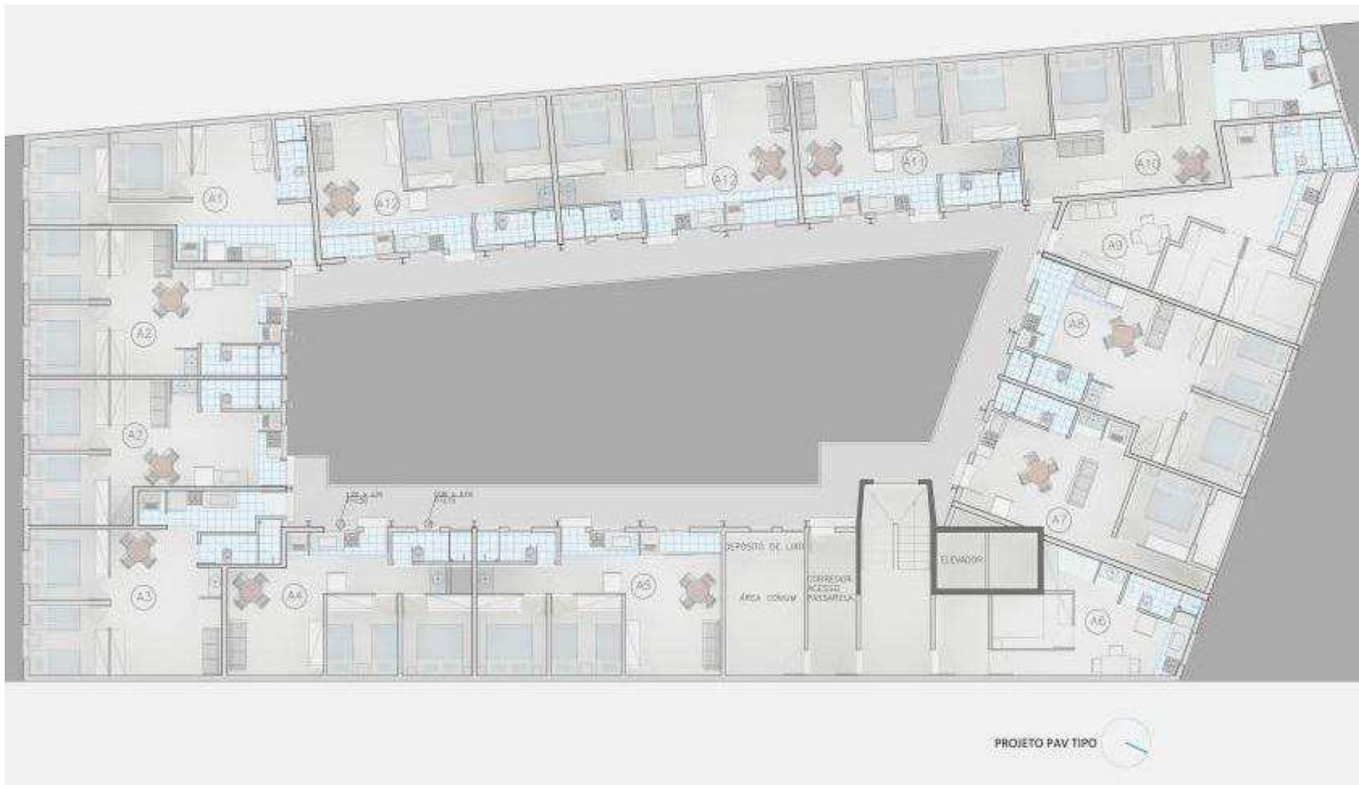
Figura 73: planta do pavimento, com o desenho das unidades.
